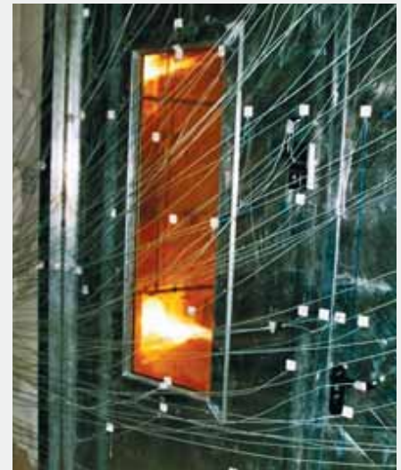
Brandprüfung mit Temperatur-Messpunkten
