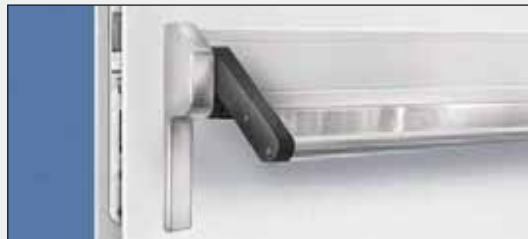
Panik-Stangengriff: Auch in verschlossenem Zustand öffnet sich die Feuerschutztür durch Herunterdrücken der Griffstange in Fluchtrichtung.
